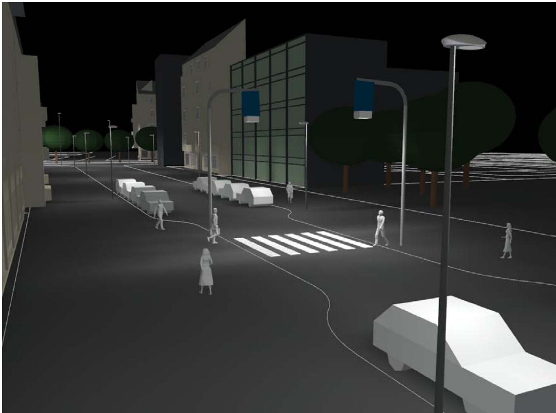
Bild 9-4 Sicherung: Vorrang am FGÜ in einer einstreifigen Innenstadtstraße, Tempo 30 km/h, mit vertikaler Beleuchtungsstärke von 10 lx durch FGÜ-Leuchte, warm-weißes Licht. (Quelle FGS)
