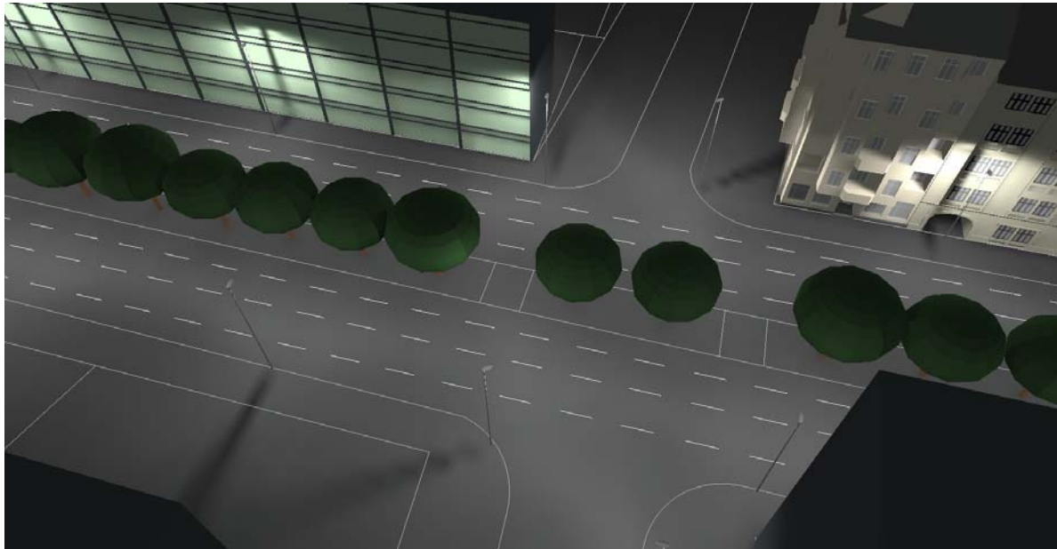
Bild 9-8 Sicherung: Nachrang an Querungsstelle einer mehrstreifigen Innenstadtstraße, Tempo 50 km/h, mit vertikaler Beleuchtungsstärke von 20 lx durch Positionierung einer Standardleuchte (Quelle FGS)
