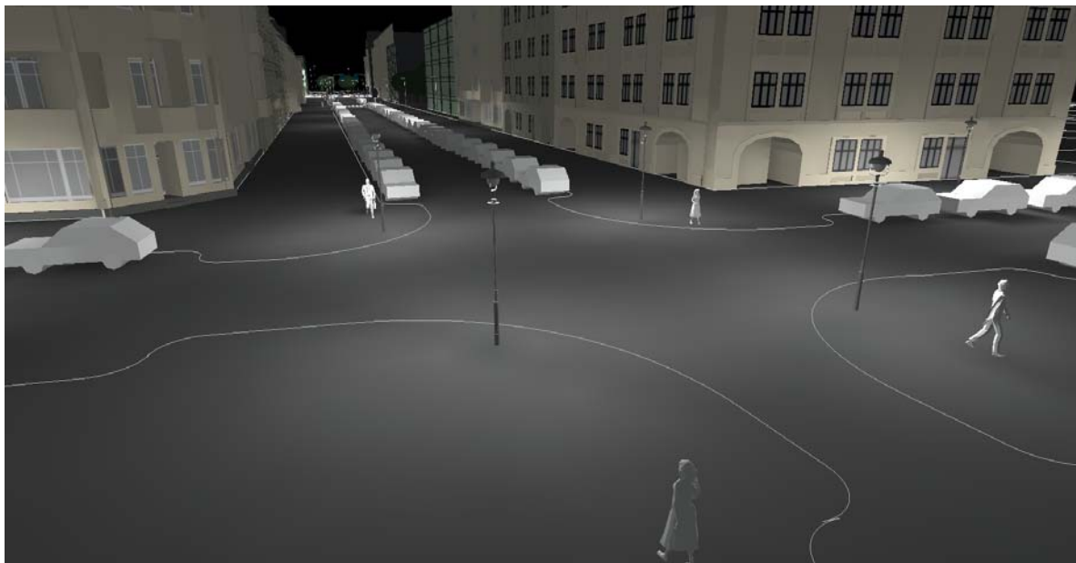
Bild 9-7 Sicherung: Vorrang an einer einstreifigen Innenstadtstraßen Kreuzung, Tempo 30 km/h, mit vertikaler Beleuchtungsstärke von 10 lx durch Standardleuchte (Quelle FGS)
