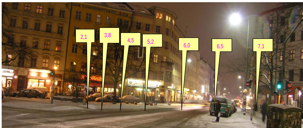
Bild 7-4 Messung der Beleuchtungsstärke (horizontal gemessen in lx) ergaben an der obengenannten Kreuzung insbesondere im Bereich der Kollision schwache Werte. Die erste Leuchte erzeugt Blendung und einen Negativ-Kontrast für die Fußgänger.
